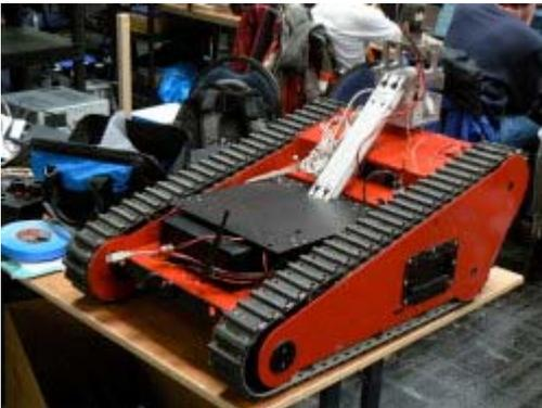
Der Roboter "Matilda" soll beim RoboCup Rescue virtuelle und physische Realität stärker zusammenführen: Software, die sich in der Simulation bewährt hat, wird danach mit dem realen Roboter in der Rescue Arena erprobt.
